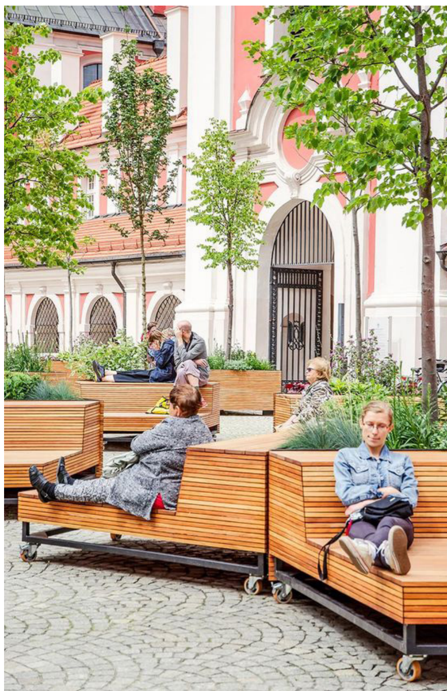
Assise individuelle posée au sol avec dispositif de pied « creux » permettant de passer la lame du tracteur pour le déplacer.
